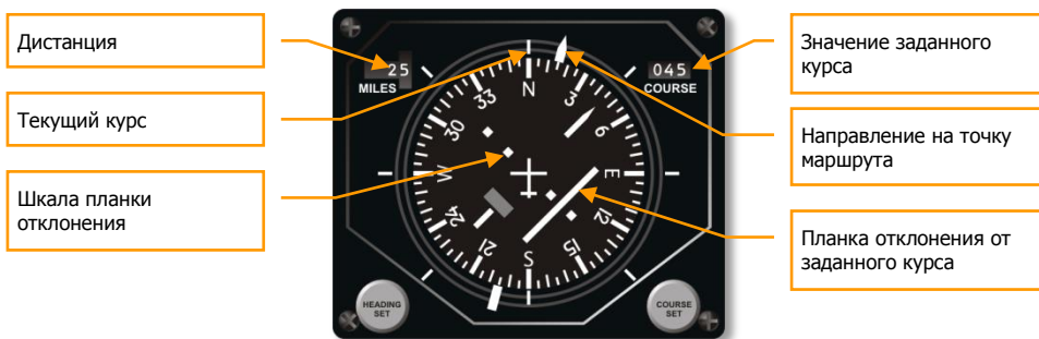
4-49: Индикатор горизонтальной обстановки (HSI)
