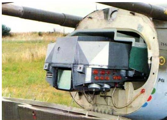
5-7: Лазерный дальномер-целуказатель "Клен-ПС" на самолете Су-25
