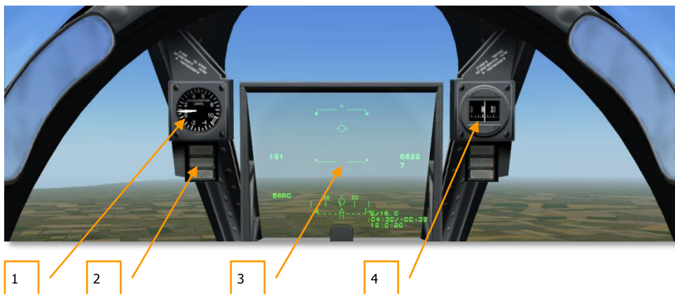
4-42: Приборы на переплете фонаря кабина самолета А-10А
